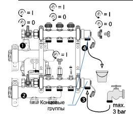
Закройте шаровые краны **①+②**. Подключите шланг для наполнения и промывки к сливному крану концевой группы **⑤** подающего коллектора; сливной кран концевой группы **④** обратного коллектора должен быть полностью открыт!
