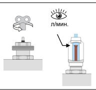
Необходимый расход теплоносителя устанавливается поворотом регулировочного шпинделя против часовой стрелки. Фактическая величина расхода теплоносителя контролируется по показаниям расходомера.
