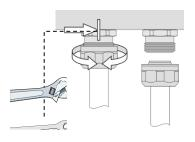
Удерживая гайку на выходе коллектора гаечным ключом SW24, закрутите накидную гайку ключом SW 30 (момент затяжки 25-30Hм). Максимально допустимый момент затяжки применяемых компрессионных фитингов не должен быть ниже указанных значений.
