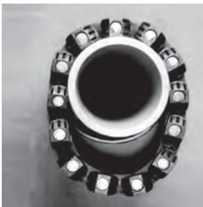
Veiller à ce que toutes les têtes de boulon soient face à l'installateur. Un petit jeu ou un léger affaissement n'a rien d'anormal. Ne pas retirer les chaînes en présence d'un petit jeu. Remarque : sur un tube de plus petit diamètre, il faudra peut-être étirer les chaînes.
