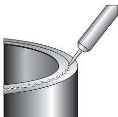
Tourner délicatement le couvercle dans le sens horaire. Ne pas endommager la garniture noire calée entre le corps et la partie supérieure.
