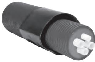
Le tube ondulé HD-PE peut être soit cimenté dans du béton, soit cimenté dans l'embrasure du mur. Environ 100 mm de tube ondulé doit ressortir afin d'étanchéiser le tube avec le manchon rétractable Microflex.
