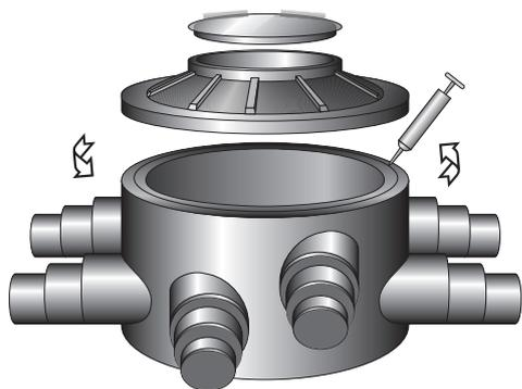
Appliquer uniformément le produit d'étanchéité d'une épaisseur de 10 mm par 10 mm de large environ sur le bord supérieur du corps du regard.
