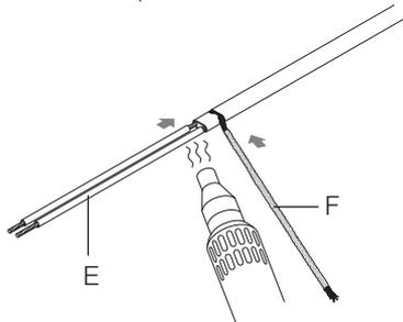
Faire glisser les manchons thermo-rétractables longs (E) sur les conducteurs et la tresse de mise à la terre torsadée (F). Rétracter délicatement à l'aide d'une source de chaleur (pistolet à air chaud ou équivalent).
