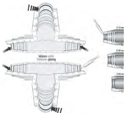
Appliquer uniformément le produit d'étanchéité sur les rainures des deux enveloppes en forme de coquille. Une épaisseur de 4 mm environ et une largeur de 5 mm environ sont recommandées.
