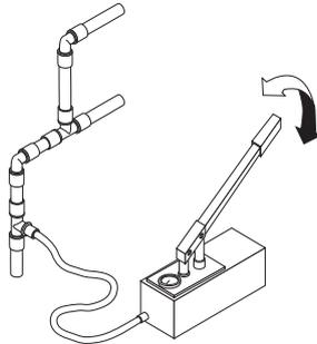
**1. Essai de pression.** Cet essai constitue une prestation complémentaire du contrat, qui fait également partie des prestations contractuelles du maître d'œuvre, même si elle n'est pas mentionnée dans le cahier des charges. Avant de la dissimuler, remplir d'eau la canalisation achevée en prenant soin d'éviter les poches d'air. L'essai de pression doit être réalisé en deux étapes, en commençant par l'essai préliminaire suivi de l'essai principal.
