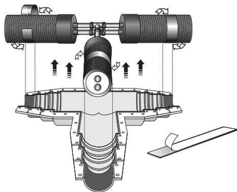
Couper les bandes de bitume de sorte qu'elles coïncident avec le diamètre externe de l'enveloppe du tube. Retirer la couche protectrice et déposer les bandes de bitume à l'intérieur des enveloppes d'isolation, aux points d'entrée du tube.
