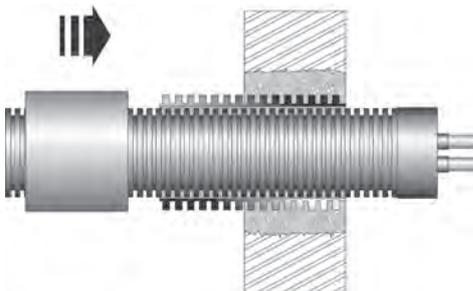
Utiliser un pistolet à air chaud pour rétracter délicatement le manchon en partie sur le tube ondulé et en partie sur l'enveloppe du tube Microflex.
