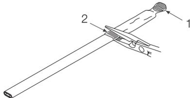
Comprimer les emplacements 1 et 2 pendant 5 secondes pour que l'adhésif fondu sorte sur les bords. Si l'adhésif ne sort pas, chauffer et comprimer à nouveau.
