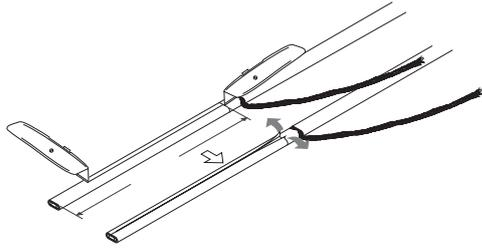
Pratiquer une coupe avec un couteau à lame rétractable aiguisé et retirer l'isolation électrique sur une longueur de 150 mm. Prendre garde à ne pas endommager les conducteurs.
