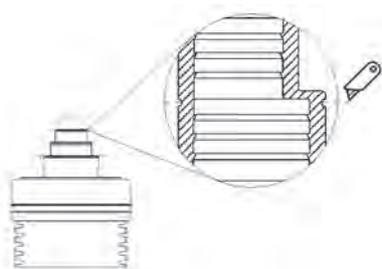
Couper le manchon pour le tube caloporteur au bon endroit (cf. schéma). Utiliser le bon outil de coupe (couteau aiguisé ou ciseaux). La coupe doit être droite et nette pour garantir l'étanchéité de l'embout terminal en caoutchouc. Tout endommagement, comme des fentes ou des déchirures sur la section coupée, peut être à l'origine de fuites.
