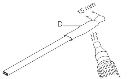
Poser le manchon thermo-rétractable (D) sur la tresse (laisser dépasser 15 mm) et rétracter à l'aide d'une source de chaleur. Passer immédiatement à l'étape suivante.
