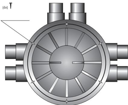
Placer le couvercle convexe sur le corps. Serrer les 6 boulons en acier inoxydable.
