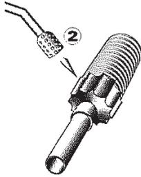
2. Utiliser un pistolet à air chaud pour rétracter délicatement le manchon.
