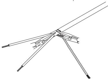
Tirer les deux conducteurs vers l'extérieur et comprimer le manchon thermo-rétractable. Si l'adhésif ne sort pas, chauffer et comprimer à nouveau.
