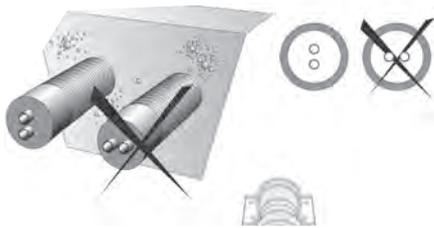
Lors de la livraison des kits d'isolation, les demi-coquilles d'isolation sont déjà reliées via des raccords à vis. Avant de les détacher, les coquilles peuvent être coupées le long d'une ligne définie pour obtenir le diamètre souhaité. La coupe doit être effectuée en ligne droite pour éviter toute possibilité de fuite.
