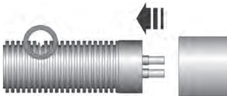
Faire glisser le manchon rétractable sur le tube Microflex endommagé.
