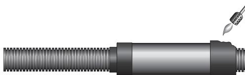
Utiliser un pistolet à air chaud ou un micro chalumeau avec une flamme jaune pâle (NE PAS utiliser de flamme bleue) pour rétracter délicatement les deux manchons en partie sur le manchon rigide et en partie sur l'enveloppe du tube Microflex.
