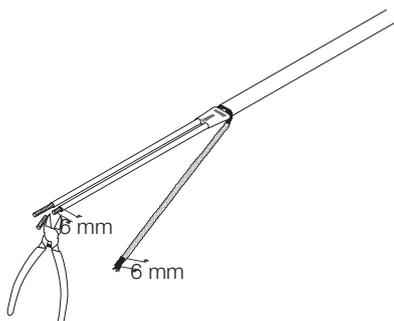
Ébarber les conducteurs pour laisser une portion dénudée sur 6 mm.
