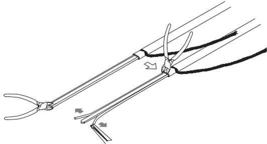
Utiliser la pince à tranchant latéral pour dénuder les extrémités des deux câbles du conducteur de l'âme. Enlever les deux conducteurs de l'âme isolée à l'aide d'une pince à becs fins. Enlever les résidus de matériau intérieur. Prendre garde à ne pas endommager les conducteurs.
