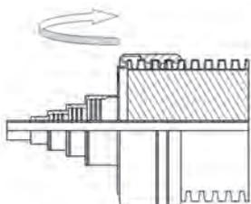
Rabattre les lèvres d'étanchéité sur l'enveloppe extérieure du tube. Les trois lèvres d'étanchéité doivent s'emboîter dans les lèvres de l'enveloppe extérieure.
