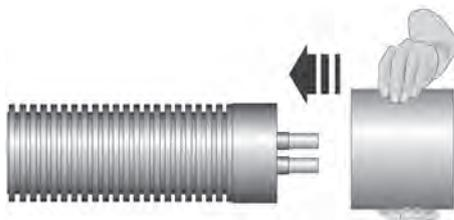
Pousser le tube Microflex dans l'enveloppe ondulée murée.
