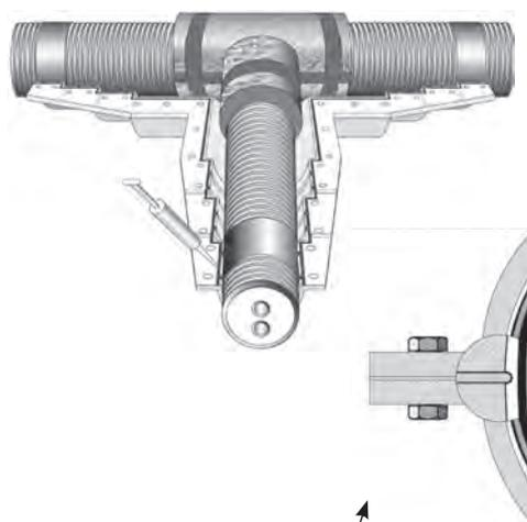
Appliquer ensuite le produit d'étanchéité uniformément le long des collerettes en haut et en bas de l'enveloppe (à proximité des trous percés) sur une épaisseur de 6 mm environ.
