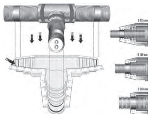
Déposer les tubes raccordés dans une enveloppe en forme de coquille.
