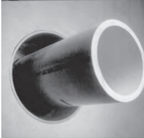
Centrer le tube dans l'embrasure du mur ou l'enveloppe. S'assurer que le tube sera adéquatement étayé aux deux extrémités. Les traversées de mur Micro Seal ne sont pas destinées à supporter le poids du tube.
