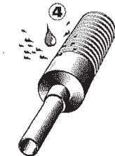
4. L'extrémité arrière du tube est désormais étanchéisée.
