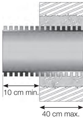
Faire glisser le manchon thermo-rétractable sur le tube Microflex.
