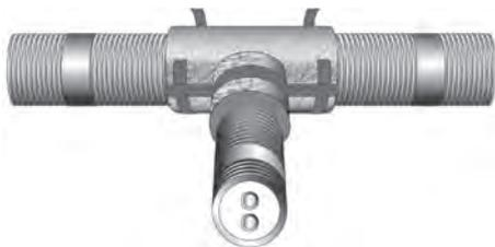
Une fois la garniture calorifuge coupée à la longueur souhaitée, elle peut être enroulée autour du tube caloporteur afin que les raccords soient convenablement recouverts. Fixer avec le ruban adhésif fourni.
