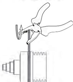
Insérer le collier de serrage fourni entre les deux anneaux. Tirer sur l'extrémité du collier de serrage dans un mouvement rotatoire et serrer autour de l'embout à l'aide d'une pince universelle.
