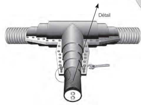
Prendre soin d'aligner correctement les deux enveloppes en forme de coquille. Serrer les boulons en acier inoxydable.
