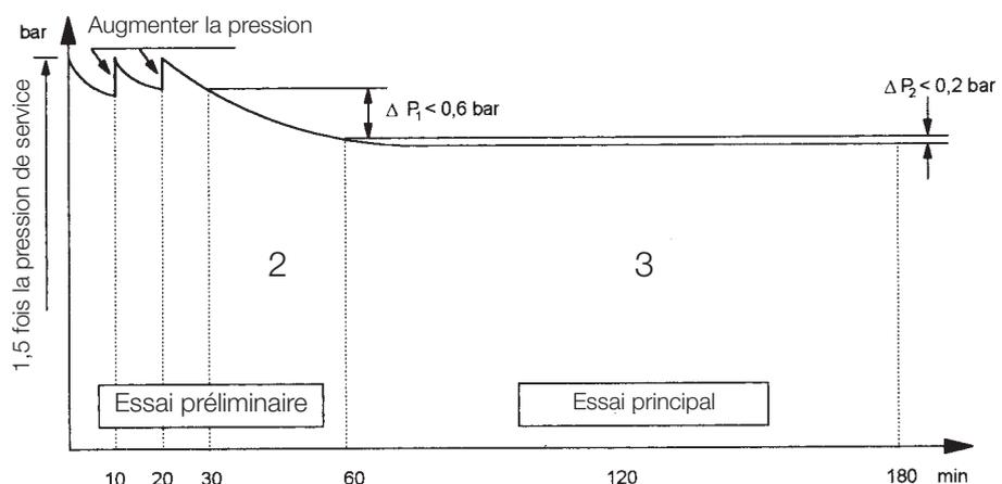
**Tester la canalisation achevée avant de la dissimuler ! L'exécution et la documentation adéquates de l'essai de pression pour le réseau de canalisation complet sont indispensables pour l'application de la garantie.**
