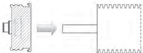
Placer l'embout terminal en caoutchouc sur le tube caloporteur et le pousser contre l'isolation. Le cas échéant, humidifier le tube caloporteur avec de l'eau. Ne pas utiliser de savon, de graisse ou d'huile pour lubrifier.
