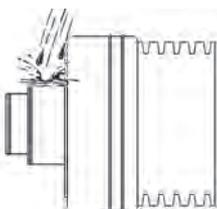
Les extrémités du tube et les embouts terminaux en caoutchouc doivent être nettoyés uniquement à l'eau avant installation.
