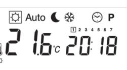
Premendo sul tasto (OK) appare la temperatura di regolazione di comfort.
