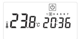
Per attivare il prodotto, portare l'interruttore in posizione "I". Apparirà la versione del software per 3 secondi. Quindi, il termostato tornerà alla modalità operativa selezionata prima di entrare in standby.
