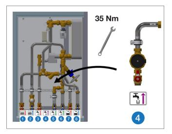
4. Kugelhahn in den Wandhalter einstecken und mit Klammern sichern.
