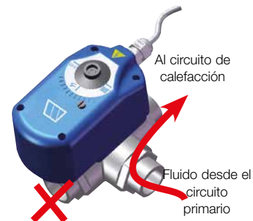
Figura 2 - Sistema WEB y calefacción
