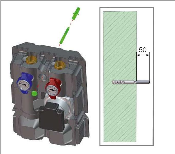
2. Bohrloch entsprechend der Schrauben- und Dübelgröße bohren.
