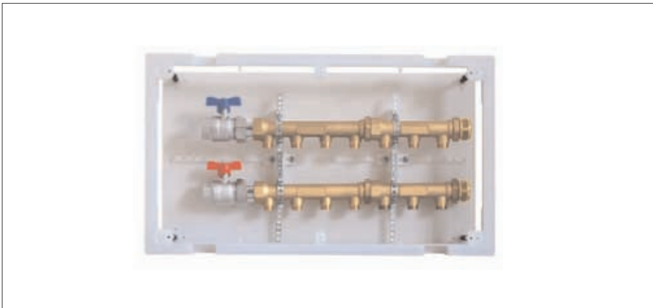
Fig. 5 Gruppo di distribuzione per alimentazione 7 corpi scaldanti (+ 1 opzionale sull'attacco di testa) in cassetta di ispezione Serie 824P (31x58) costituito da collettore componibile Serie 805M, valvole di intercettazione (Serie 210), tappo 834M.
