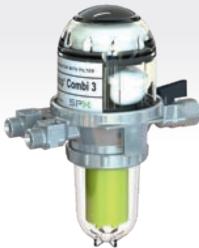
TC3 110A Tigerloop Combi 3 - Stookolieontluchter met ingebouwde filter (50 µm) en afsluitkraan. Geen retourleiding meer nodig. Verminderd risico op lekkage. Vereenvoudigde installatie.
