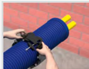
2. Die Kettenabdichtung LS am Außenmantel anbringen. Sicherstellen, dass der gerade Rohrabschnitt vor und nach der Kettenabdichtung min. 60 cm beträgt. Krümmungen sind nicht zulässig.
