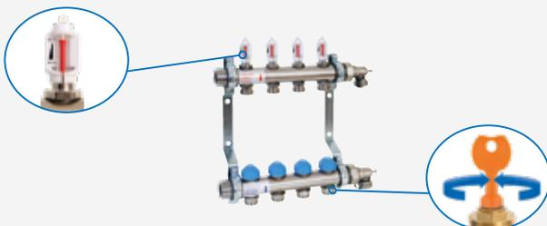
Der gewünschte Volumestrom in l/min wird am dynamischen Regulierventil anhand des Einstellungsschlüssels eingestellt.
