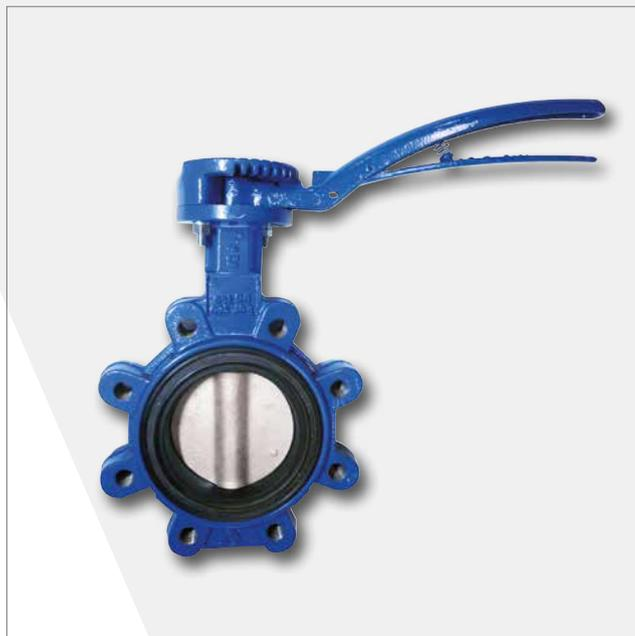
Valvole a farfalla SYLAX, orecchie filettate, disco in acciaio ACCIAIO INOX, manicotto in EPDM con leva manuale dentellata in ghisa, corpo in ghisa sferoidale
